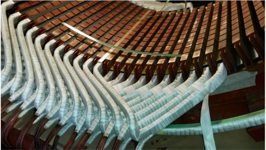
stator d'un alternateur de centrale hydraulique
