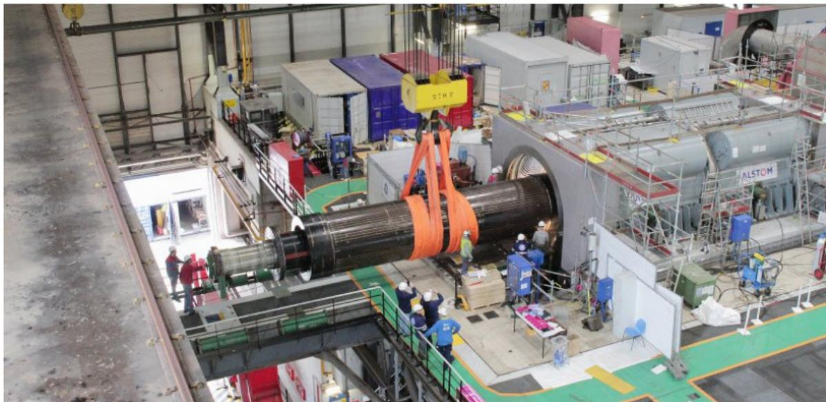
rotor d'un turbo-alternateur
