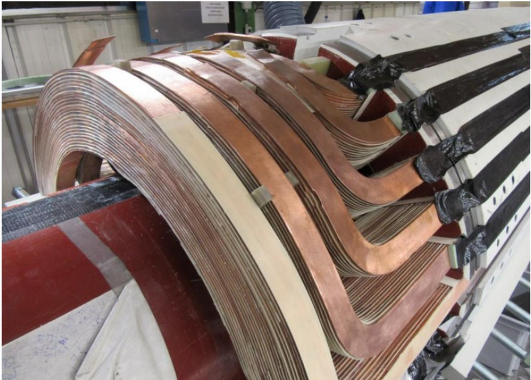
rotor d'un turbo-alternateur
