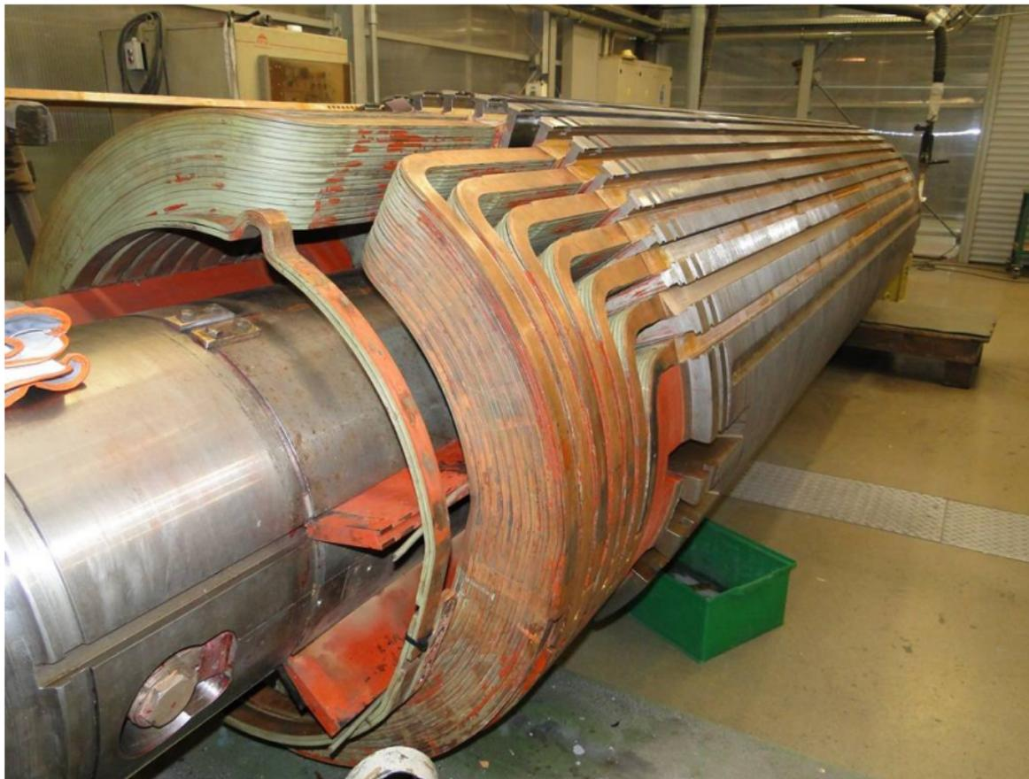
les enroulements des 2 pôles du rotor d'un turbo-alternateur
