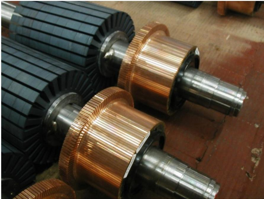
FIGURE 1.12 – Collecteur d'une machine à courant continu de forte puissance.
