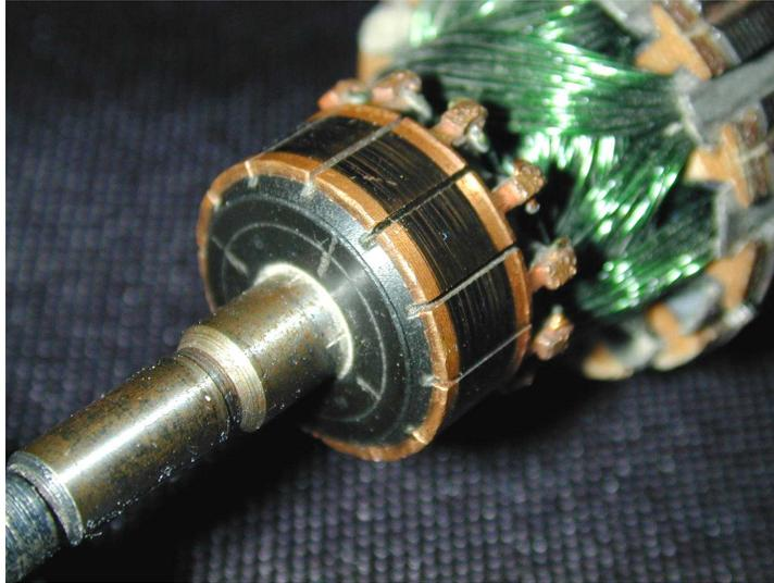
FIGURE 1.11 – Collecteur d'une machine à courant continu de faible puissance.
