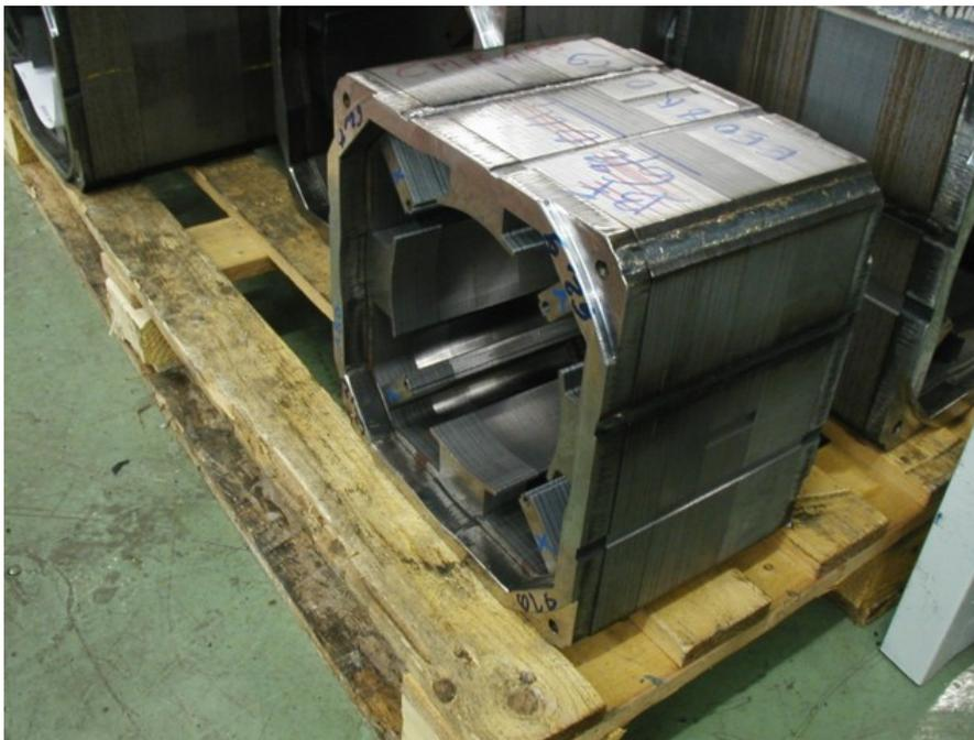
FIGURE 1.4 – Culasse, circuit magnétique statorique d'une machine à courant continu.
