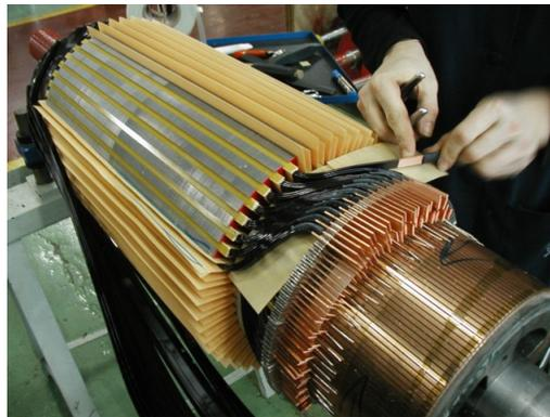
FIGURE 1.7 – Mise en place des conducteurs d'induit dans les encoches et soudure de ceux-ci sur le collecteur.
