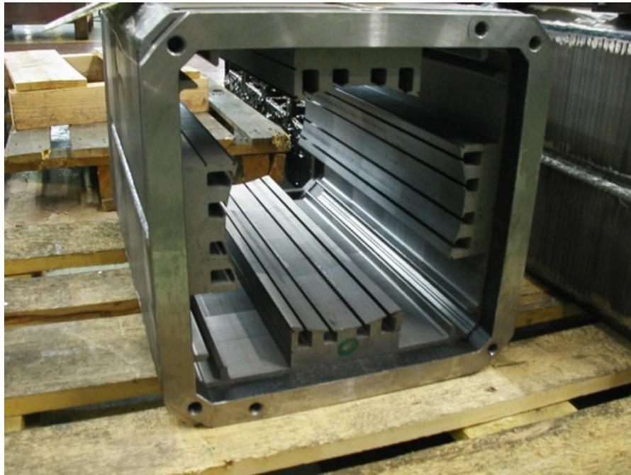
FIGURE 1.3 – Culasse, circuit magnétique statorique d'une machine à courant continu.
