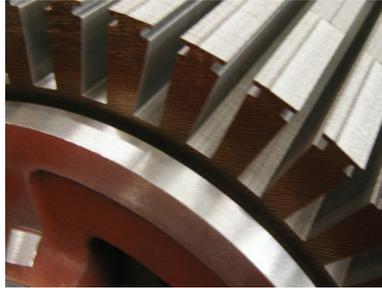
FIGURE 1.6 – Encoche sur l'induit destinée à recevoir les conducteurs dits actifs.
