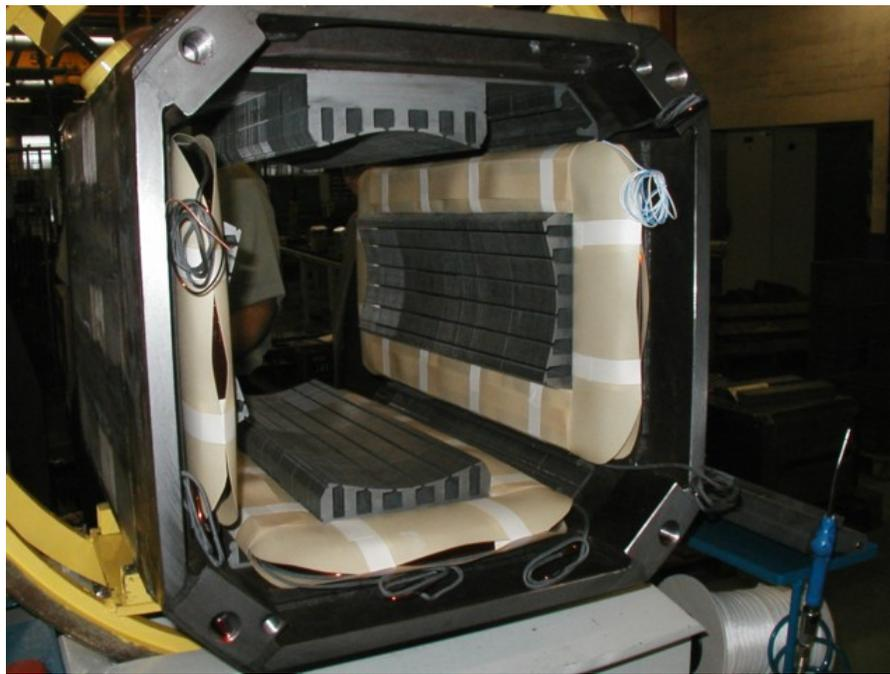
FIGURE 1.5 – mise en place des bobines sur le circuit magnétique statorique d'une machine à courant continu.
