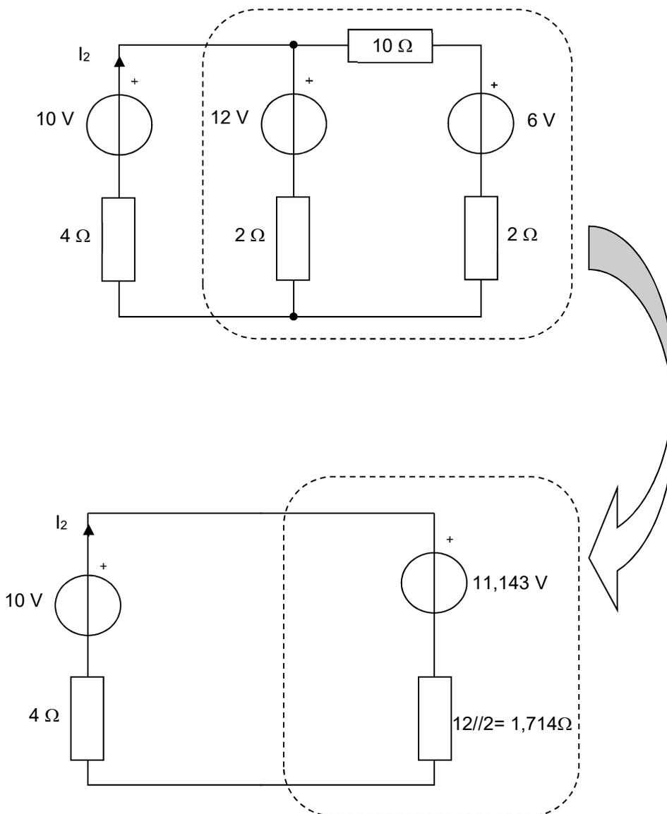
$$I_2 = \frac{10 - 11,1429}{4 + 1,714} = -0,2 \text{ A} , \text{ le courant } I_2 \text{ descend donc du haut vers le bas sur le schéma.}$$
