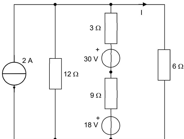
On remplace ensuite les deux générateurs de tension en série par un générateur de tension équivalent :
