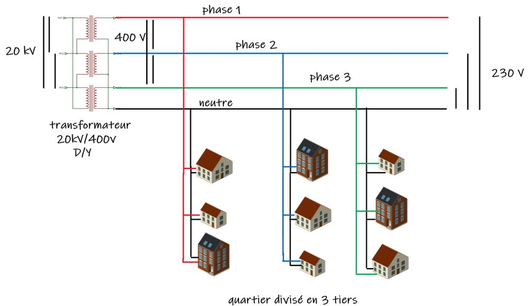
FIGURE 2: Distribution d'énergie électrique en monophasé pour les installations « domestiques ».
