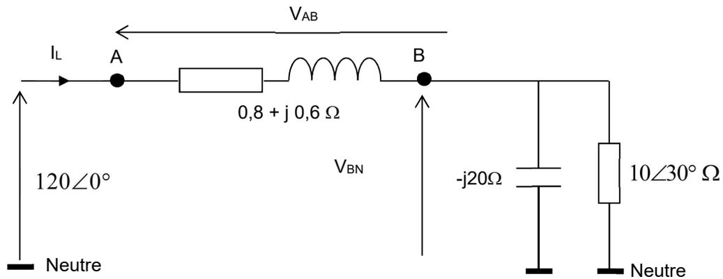
On transforme le triangle de condensateur en une étoile (Kennelly). Le condensateur ( $-j20\ \Omega$ ) et l'impédance  $10\angle30^\circ$  sont en parallèle donc l'impédance équivalente est :
