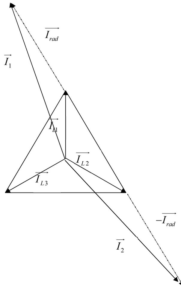
$$\underline{I}_1 = \underline{I}_{1Lampes} + \underline{I}_{radiateur} = 7,3 \angle 90^\circ + 10 \angle 120^\circ = 16,7 \angle 107,4^\circ \text{ A}$$
