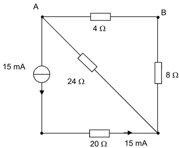
L'intensité de 15 mA traverse le diviseur de courant constitué de la résistance de 24 Ω en parallèle avec les résistances de 8 et de 4 Ω en série :
