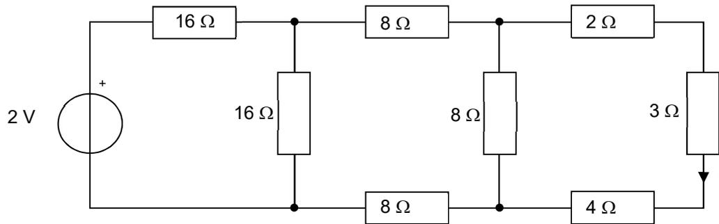
6. Calculer I par le principe de superposition, puis simplifier le schéma à gauche des points A et B.
