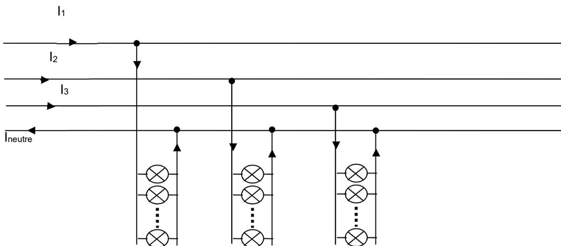
Ainsi :  $\vec{I}_{neutre} = \vec{I}_{1L} + \vec{I}_{2L} + \vec{I}_{3L}$ . Comme les intensités sont des vecteurs de même module et déphasés de  $120^\circ$ , leur somme est nulle ainsi que l'intensité dans le conducteur neutre.
