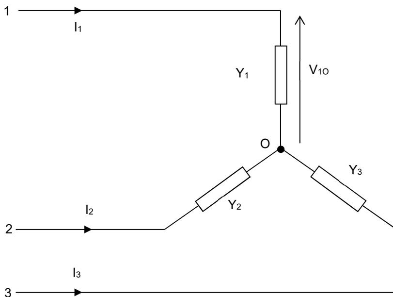
On peut exprimer les courants circulant dans les phases en fonction des admittances ( $1/Z$ ) des dipôles composants le récepteur :
