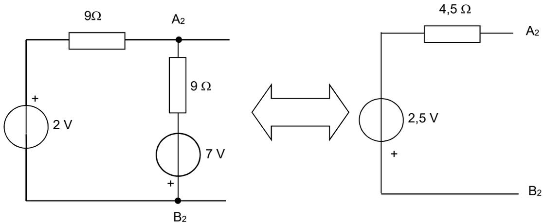
**Attention** : le signe moins trouvé pour  $E_{ThA_2B_2} = V_{A_2} - V_{B_2}$  signifie que le point B<sub>2</sub> est à un potentiel plus élevé que A<sub>2</sub>. Ainsi nous portons le signe plus sur B<sub>2</sub>.
