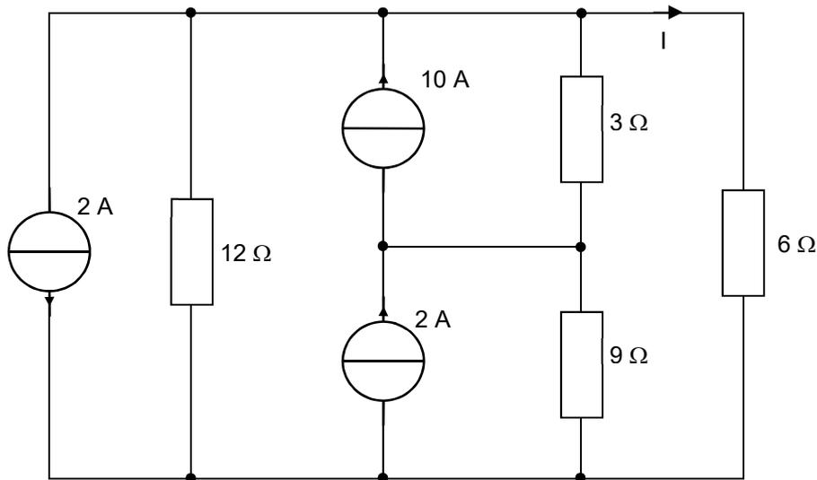
On remplace ensuite les générateurs de courant par leur équivalent sous forme de générateur de tension :
