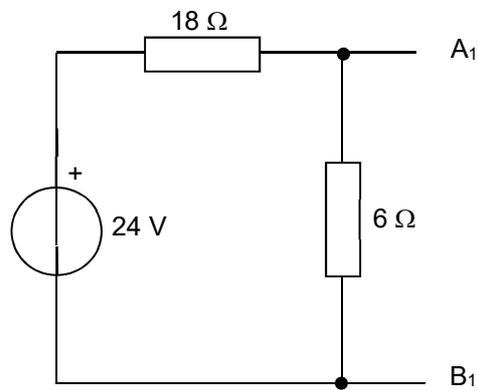
Déterminons le générateur équivalent de Thevenin entre A<sub>1</sub> et B<sub>1</sub> :
