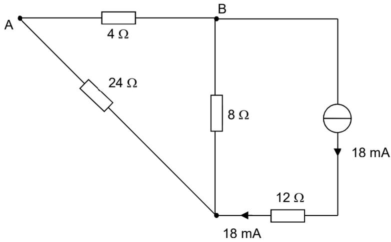
Le courant de 18 mA se divise dans le diviseur constitué de la résistance de 8 Ω d'une part et des résistances de 24 et 4 Ω en série d'autre part :
