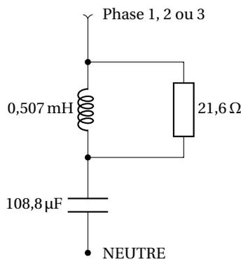
FIGURE 2 – Ce qu'il faut retenir du schéma technique : entre une phase et le neutre.
