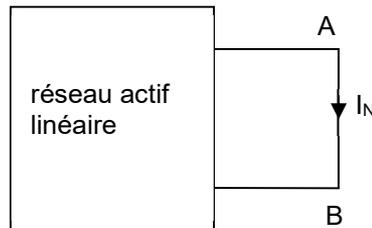
Calcul de la résistance  $R_N$  (impédance  $Z_N$ ) : on éteint toutes les sources et on calcule ou on mesure la résistance (l'impédance) entre A et B.
