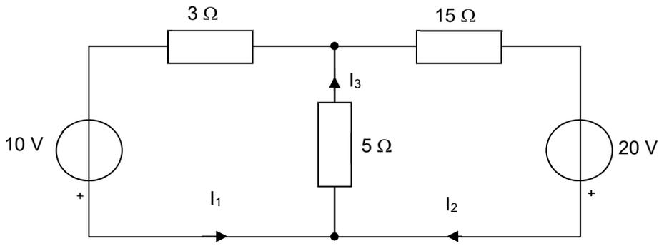
Déterminons  $I_1$ , pour cela nous remplacerons la maille de droite par un générateur de Thevenin équivalent :
