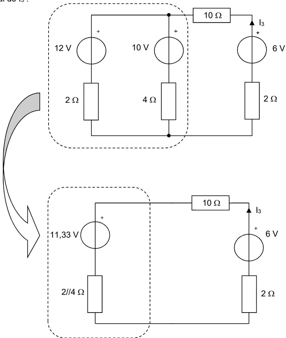
$$I_3 = \frac{6 - 11,333}{10 + 2 + (2 // 4)} = -0,40 \text{ A}, \text{ ici également, le courant } I_3 \text{ circule dans le sens contraire de la flèche.}$$
