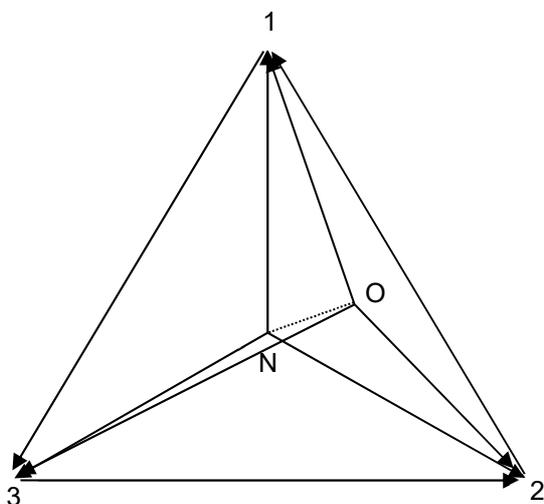
$$\underline{V}_{1O} = \underline{V}_{1N} + \underline{V}_{NO}, \quad \underline{V}_{2O} = \underline{V}_{2N} + \underline{V}_{NO}, \quad \underline{V}_{3O} = \underline{V}_{3N} + \underline{V}_{NO} \quad (4)$$
