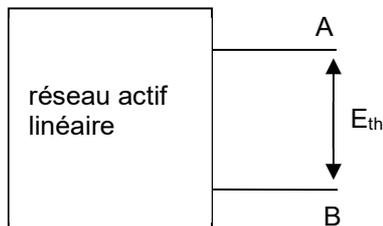
Calcul de la résistance  $R_{th}$  (impédance  $Z_{th}$ ) : on éteint toutes les sources et on calcule ou on mesure la résistance (l'impédance) entre A et B.
