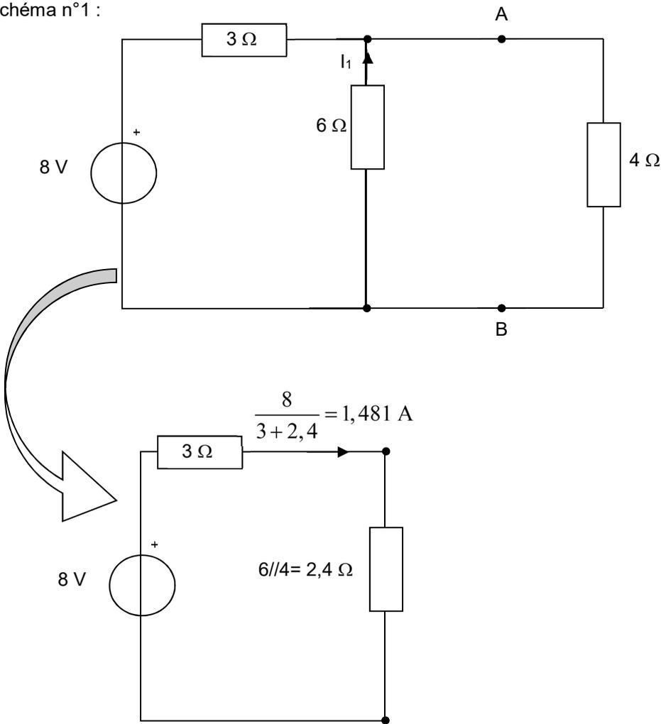
La formule du diviseur de courant nous permet de déterminer  $I_1$  :
