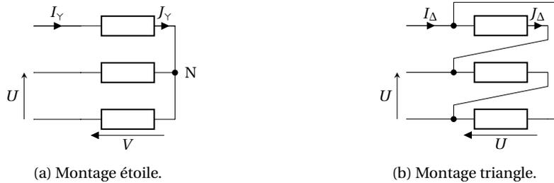
FIGURE 1: Récepteur triphasé couplé en  $\gamma$  (1a) et en  $\Delta$  (1b).
