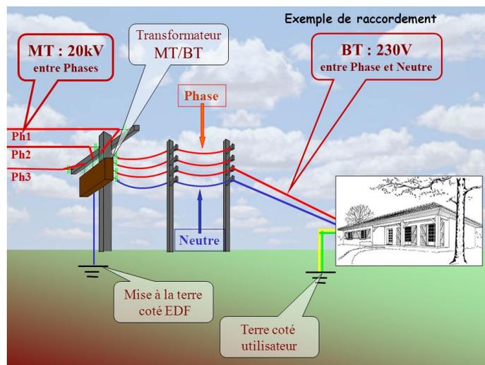
FIGURE 4: Exemple de raccordement d'une alimentation domestique.
