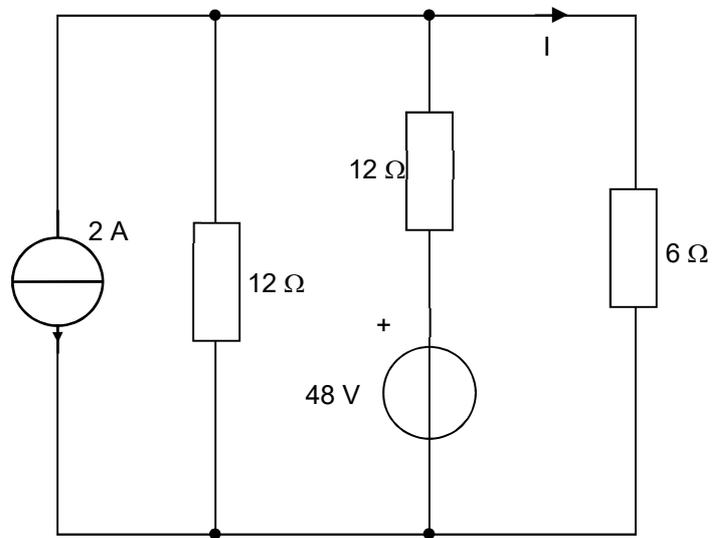
On remplace le générateur de tension par son équivalent sous forme de générateur de courant :
