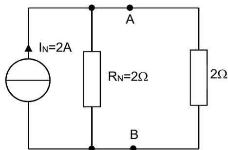
$R_N$  et la résistance de  $2\Omega$  constituent un diviseur de courant pour  $I_N$ . Etant donné qu'elles ont même valeur,  $I_N$  sera divisé par deux. Par conséquent, l'intensité qui passe dans la résistance de  $2\Omega$  est de 1A.
