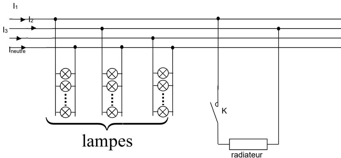
5. Pour alimenter une installation électrique on dispose d'un réseau triphasé 220/380 V, 50 Hz. Le réseau est utilisé pour alimenter une installation électrique comprenant :
