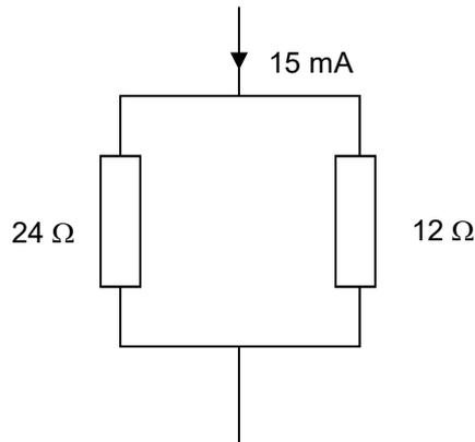
Soit une intensité de :  $15 \times \frac{24}{24 + 12} = 10 \text{ mA}$  et donc pour ce sous circuit,  $V_{AB} = -40 \text{ mV}$  (attention au sens du courant !).
