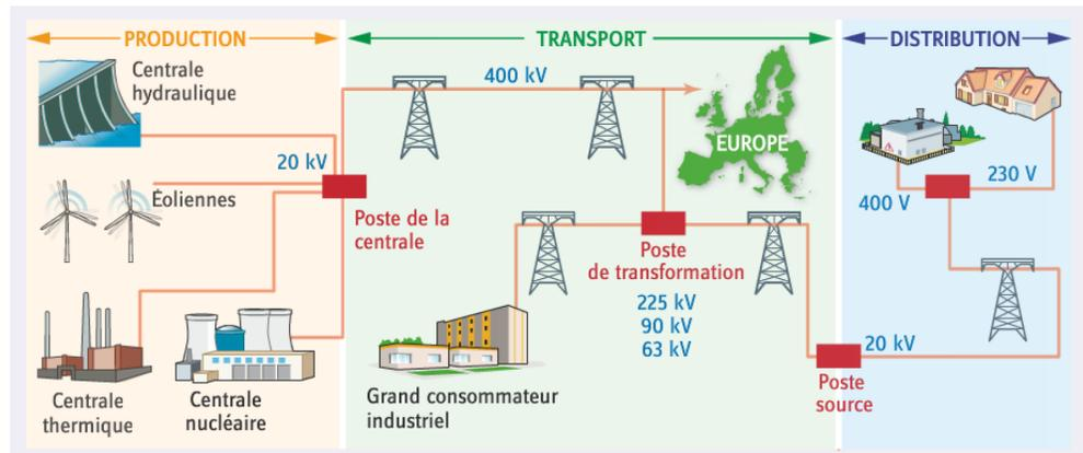
FIGURE 1: Production, transport et distribution de l'énergie électrique en triphasé.
