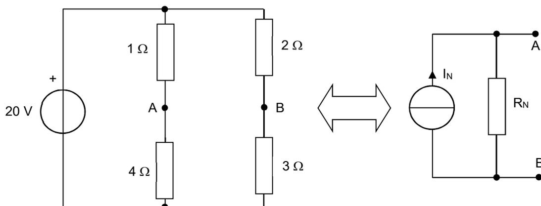
Nous reprenons le même exemple d'application que pour le théorème de Thevenin, à savoir la détermination de l'intensité dans la résistance  $R = 2 \Omega$  sur le schéma de la Figure 15.
