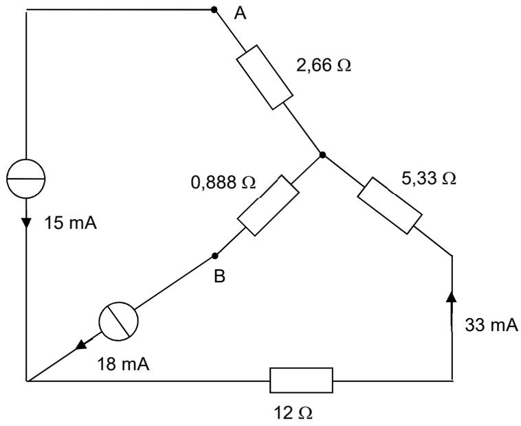
$$V_{AB} = 0,888 \times 18 \cdot 10^{-3} - 2,66 \times 15 \cdot 10^{-3} = 24 \text{ mV}$$
