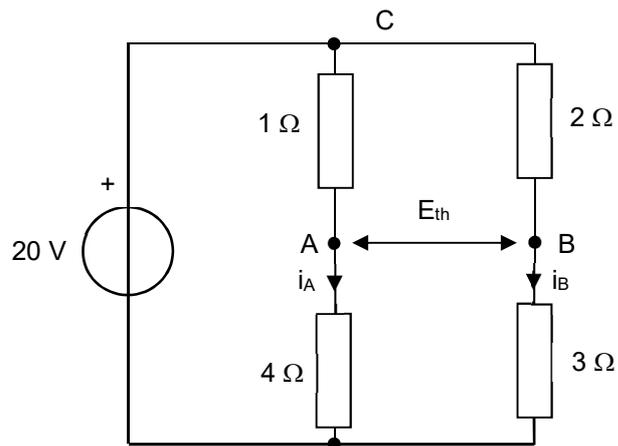
Nous allons calculer les intensités  $i_A$  et  $i_B$  puis les d.d.p.  $V_{CA}$  et  $V_{CB}$ . L'équation de la maille CAB permettra d'obtenir  $V_{AB} = E_{th}$ .
