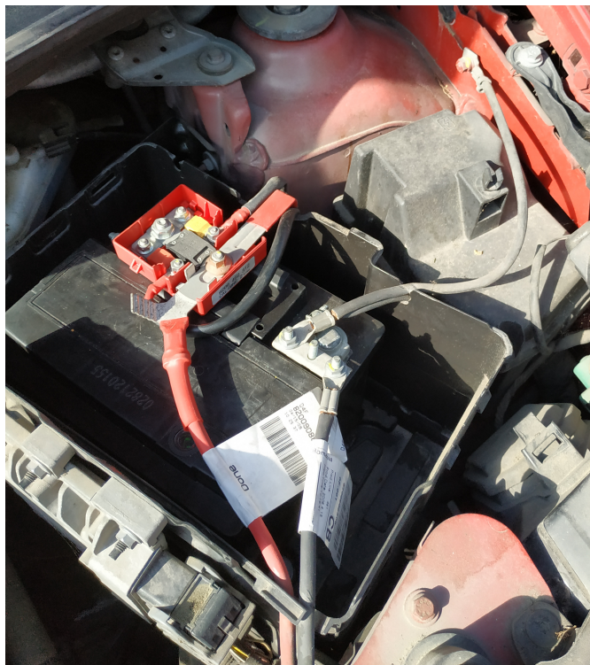
FIGURE 2.3 – La borne moins de la batterie est reliée à la carrosserie de la voiture, la carrosserie est la masse et fait office de conducteur de retour pour l'intensité.
