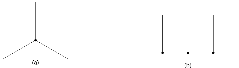
FIGURE 2.5 – Différentes représentation d'un nœud, nœud « éclaté » en (b)
