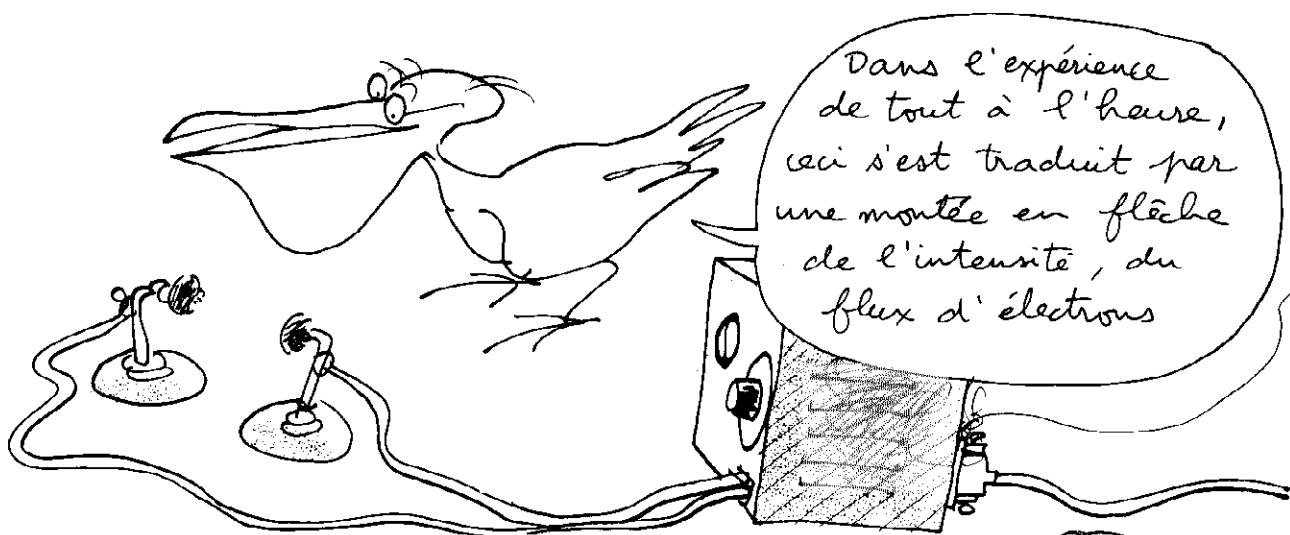
Autrement dit, le gaz situé entre les électrodes est devenu soudain très conducteur. Le générateur, placé en situation de **COURT-CIRCUIT**, a cramé.
