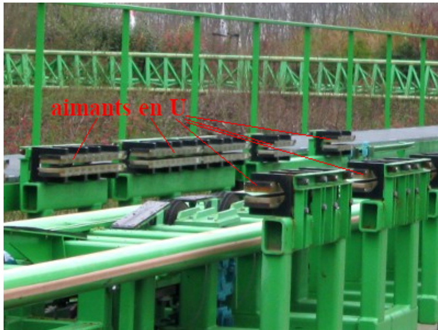
FIGURE 6.5 – Frein linéaire à courants de Foucault installé sur une montagne russe, on peut voir les aimants permanents en U.
