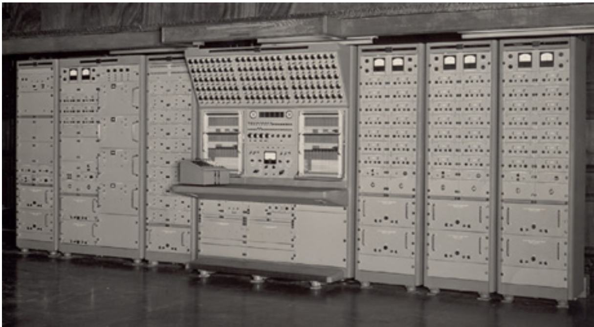
Calculateur analogique des années 1950/1960 réalisé à base d'amplificateurs opérationnels à tubes
