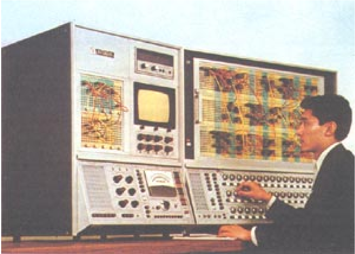
Calculateur analogique des années 1970 à base d'ampli-op
